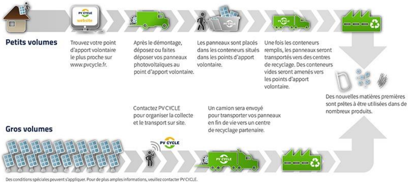
Figure 156 - Fonctionnement de la filière de recyclage des modules photovoltaïques en fin de vie (Source : PV Cycle).
